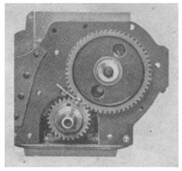
FIG. 8 -- TIMING GEAR MARKS
